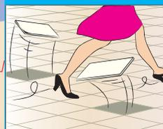
Décrolement de carrelages dans un centre commercial suite à des délais trop tendus pour l'exécution de la pose du carrelage et mise en exploitation prématurée.
